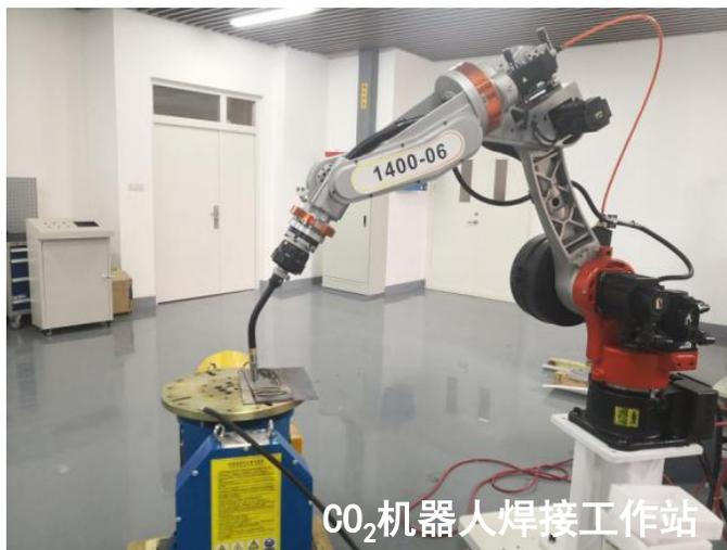
CO<sub>2</sub>机器人焊接工作站
